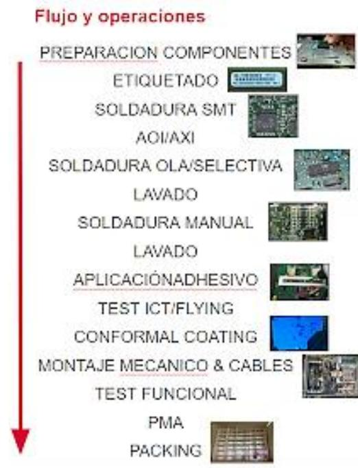
*Ilustración 7: Proceso de fabricación PCB.*
