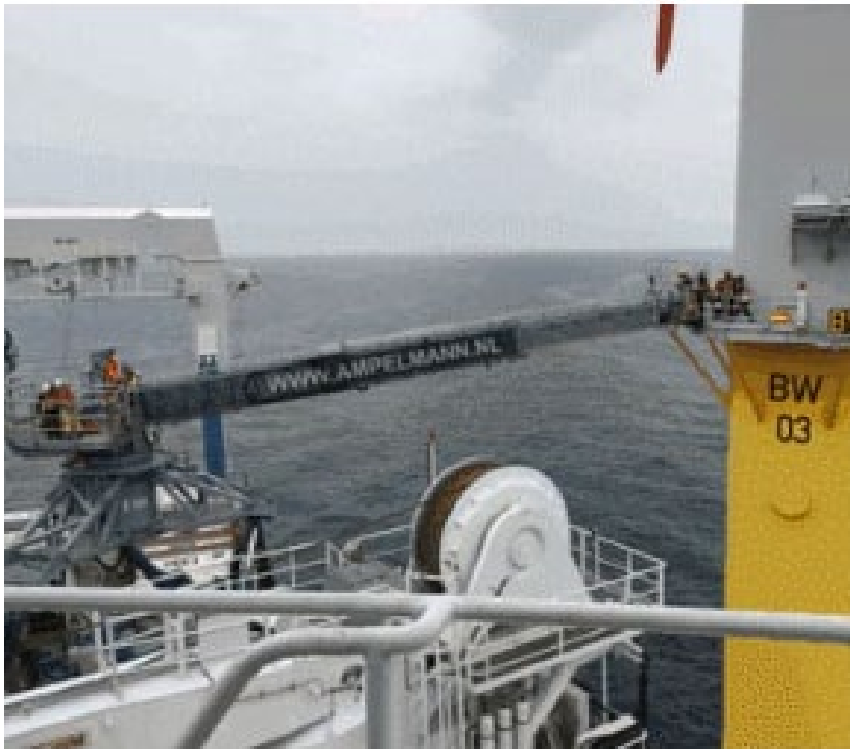
Figura 7. Acceso a un aerogenerador offshore mediante pasarela. [1]
