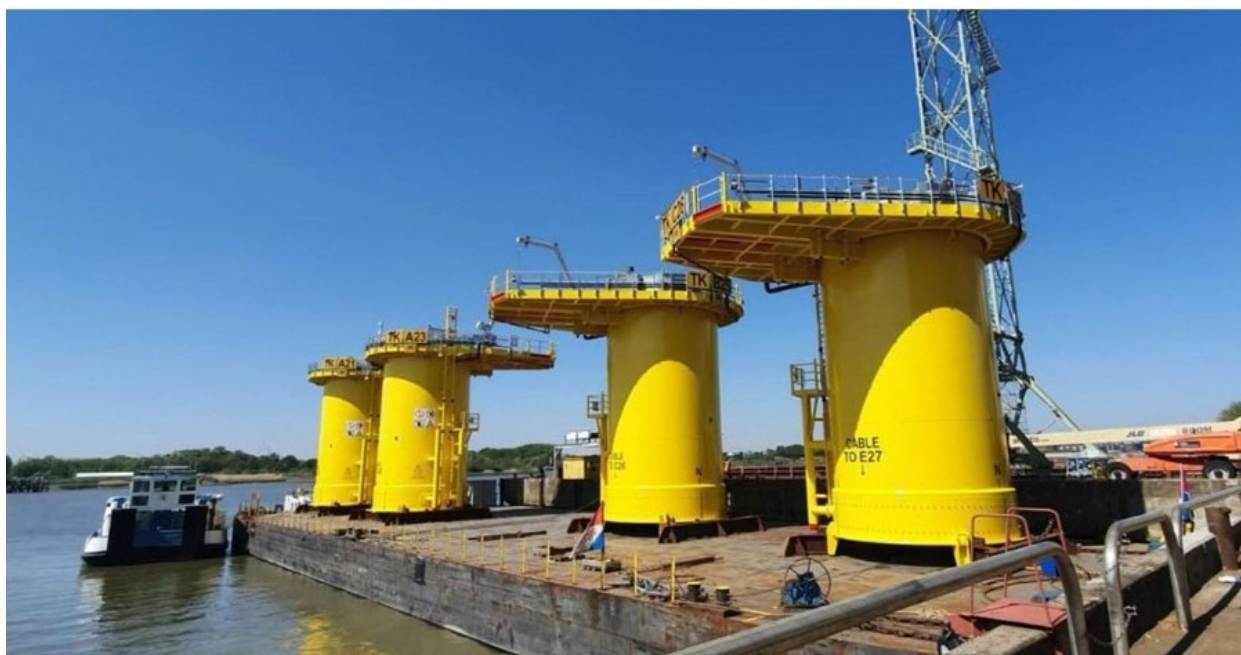
Figura 16. Pieza de transición para parques eólicos. [30]
