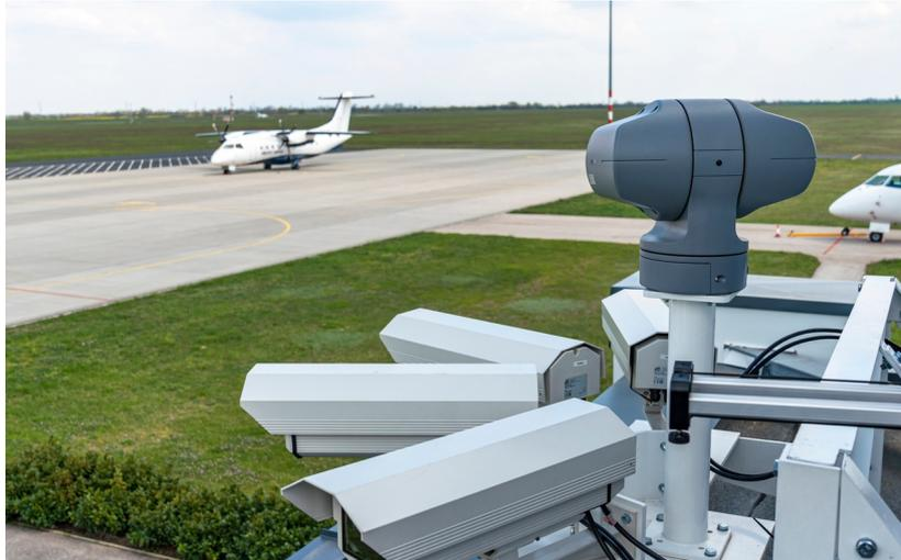
Fig. 3.4. Torre de control remota: disposición de las cámaras y sensores. Disponible en: <https://lc.cx/ksgo0Q>.
