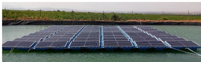
*Ilustración 9. Estructura flotante. Fuente: Intergia.*
