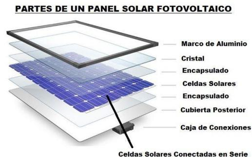
*Ilustración 2. Partes de un panel solar. Fuente: Área tecnología.*
