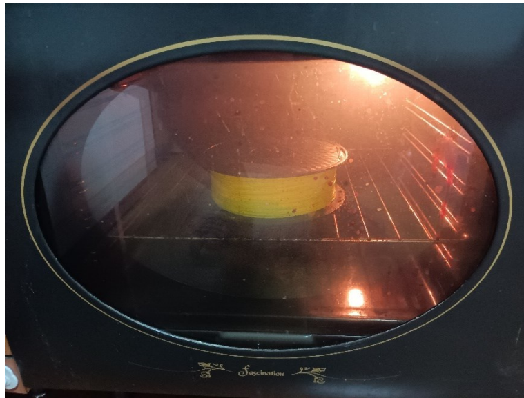
Ilustración 47 - Secado de filamento al horno.
