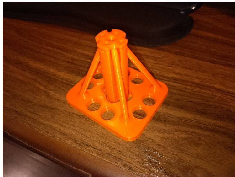
Ilustración 17 - Soporte impreso aún con las ayudas para la impresión.
