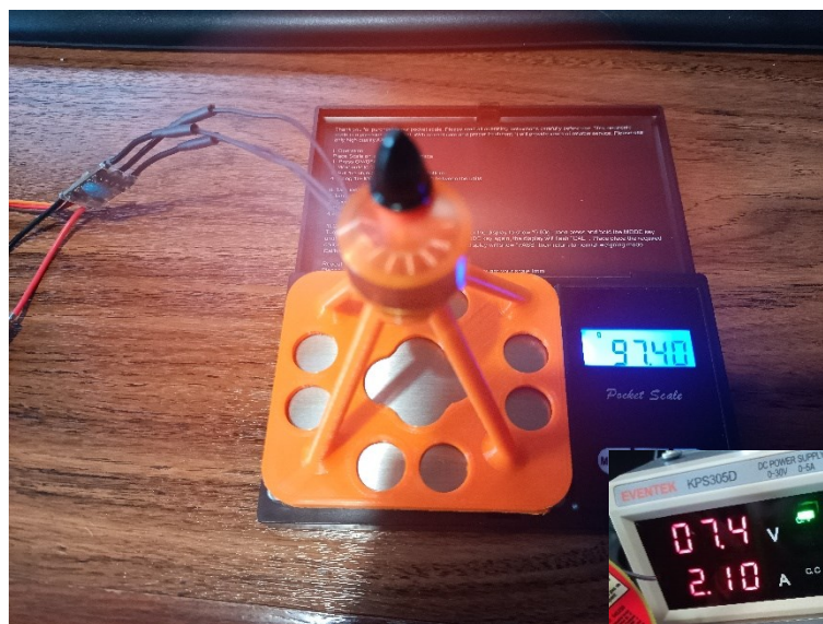
Ilustración 19 - Medidas de tracción y consumo eléctrico.
