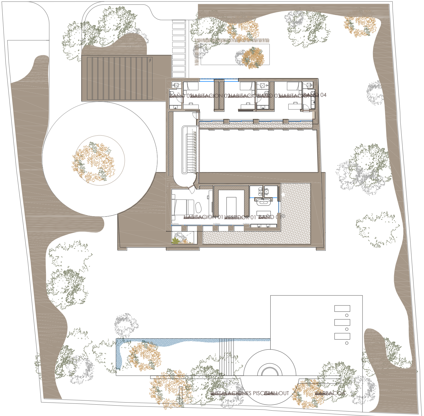
Ilustración 39.- Planta primera de la vivienda.
