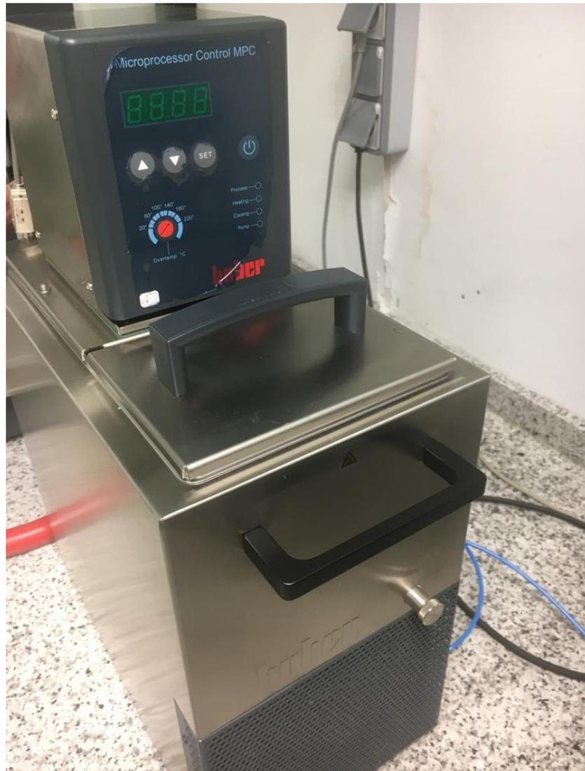
*Figura 3.3: Termostato del reómetro.*
