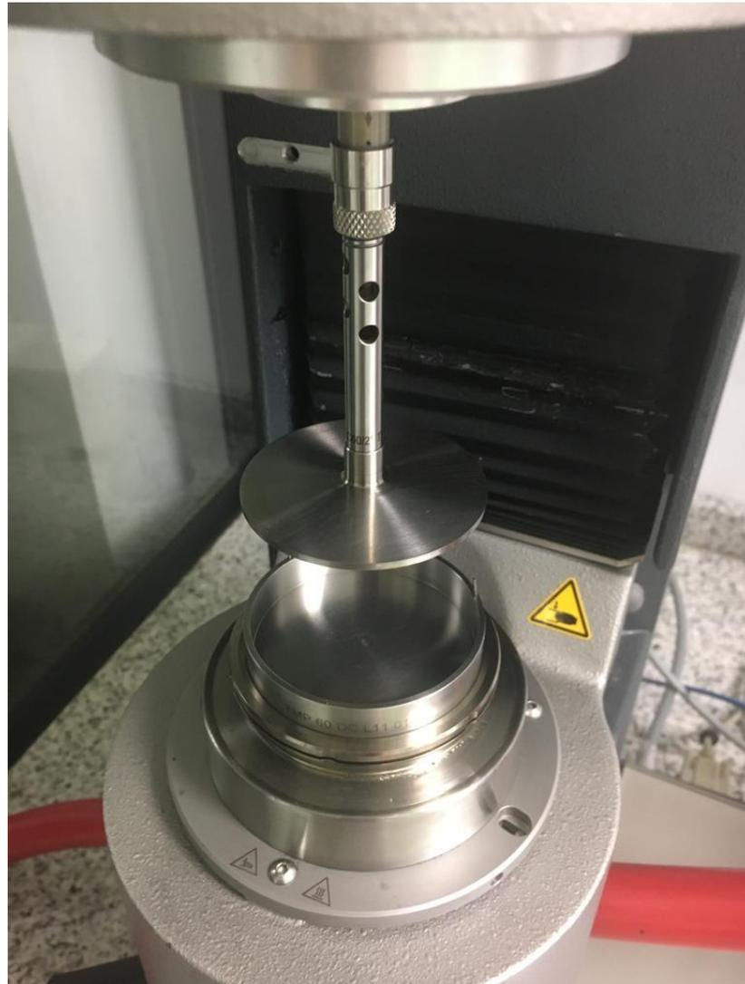
*Figura 3.4: Sistema de placa-cono del reómetro.*
