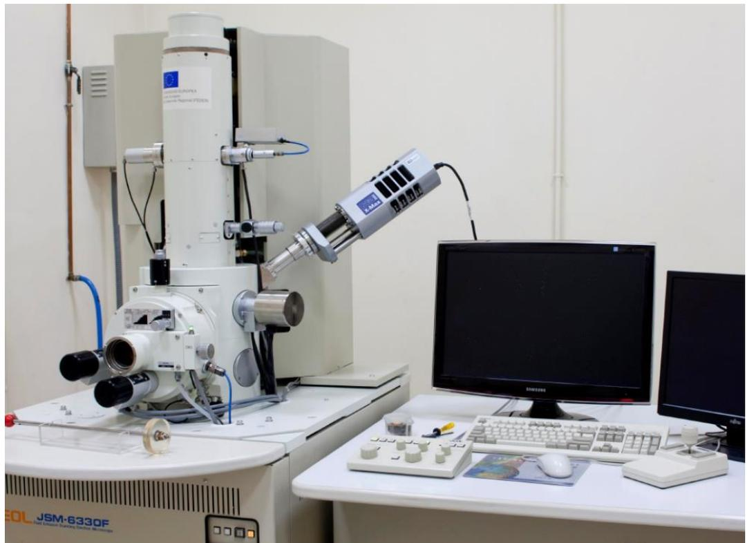
Figura 3.8: Microscopio electrónico de barrido del CNME [22].
