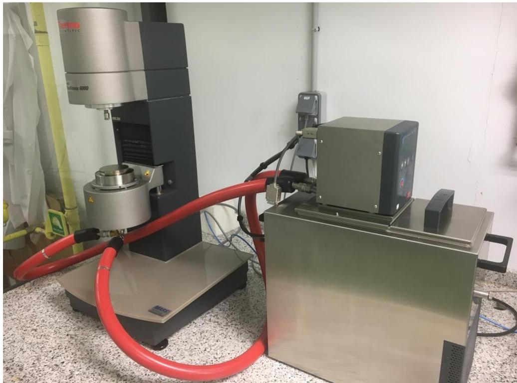
*Figura 3.2: Reómetro Haake Rheostress 6000.*
