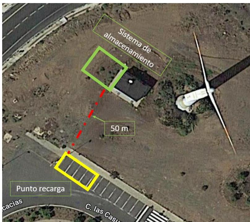
Imagen 21. Emplazamiento de prefabricado sistema almacenamiento y puntos de recarga. (Google Mpas y elaboración propia).
