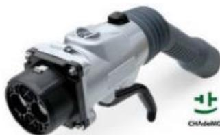
Este conector pertenece al tipo 4 estipulado en la norma IEC 62196-2. Está constituido por 10 patillas, dos para las fases, siete para tema de comunicaciones y señalizaciones y uno de uso libre. Tiene una capacidad de 200 amperios y 500 voltios en corriente continua.
