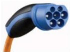
Este conector pertenece al tipo 2 estipulado en la norma IEC 62196-2. Está constituido por siete patillas, utiliza tres para las fases uno para el neutro, uno para el cable de tierra y dos para señalización. Tiene una capacidad de 70 amperios para 230 voltios y 63 amperios para 400 voltios. Es el conector estándar en Europa.
