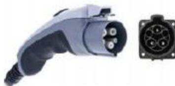
Este conector pertenece al tipo 1 estipulado en la norma IEC 62196-2. Está constituido por 5 patillas, dos de ellas para la fase y el neutro, las otras dos para señalar y otro para el cable de tierra. Tienen una capacidad de 32 amperios y 230 V.
