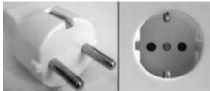
El conector tipo Schuko es el estandarizado para viviendas, puede ser sobre pared o empotrado, y como se ve en la imagen tiene dos entradas para la fase y para el neutro y una patilla para la tierra. Es utilizado para el método A y B, utilizado también para la bici eléctrica. La característica eléctrica es de 16 A y 2030 V.
