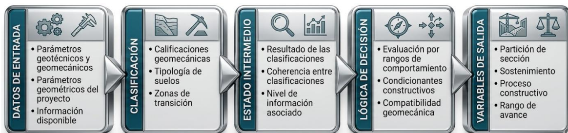
Figura 55. Esquema conceptual de la estrategia de decisión de la herramienta. Fuente: Elaboración propia
