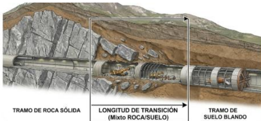
Figura 59. Representación de longitud de transición. Fuente: Elaboración propia
