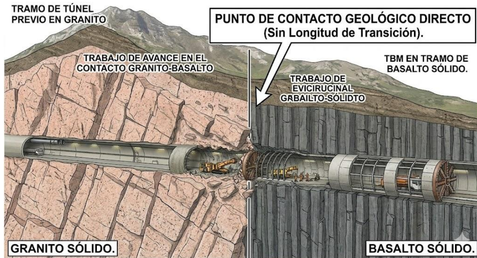
Figura 60. Representación de cambio de tipo de litología sin longitud de transición. Fuente: Elaboración propia
