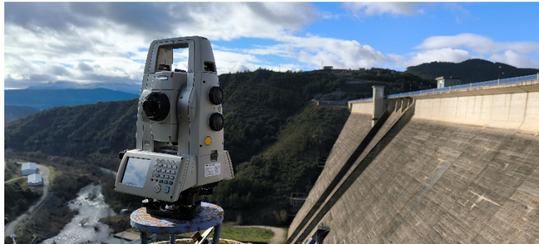
Ilustración 24. Estación total robotizada. Fuente: PROESZA, S.L. (Elaboración propia)
