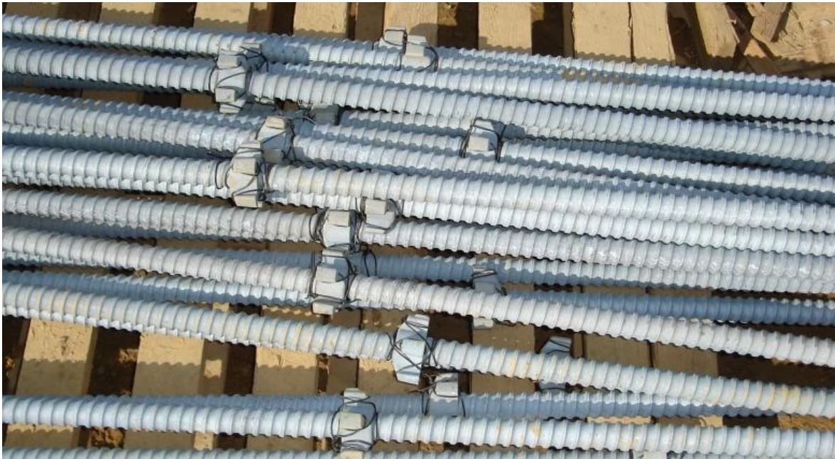
Figura 27: Centradores de acero en barra hueca roscada de acero (Fuente: Soil Nail Walls – Reference Manual (FHWA, 2015))
