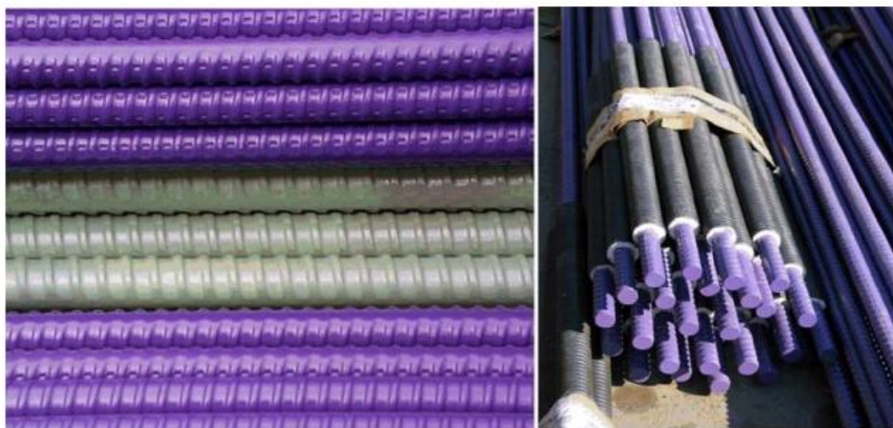
Figura 31: Barras protegidas con revestimiento epóxico gris y púrpura (Fuente: Soil Nail Walls – Reference Manual (FHWA, 2015))
