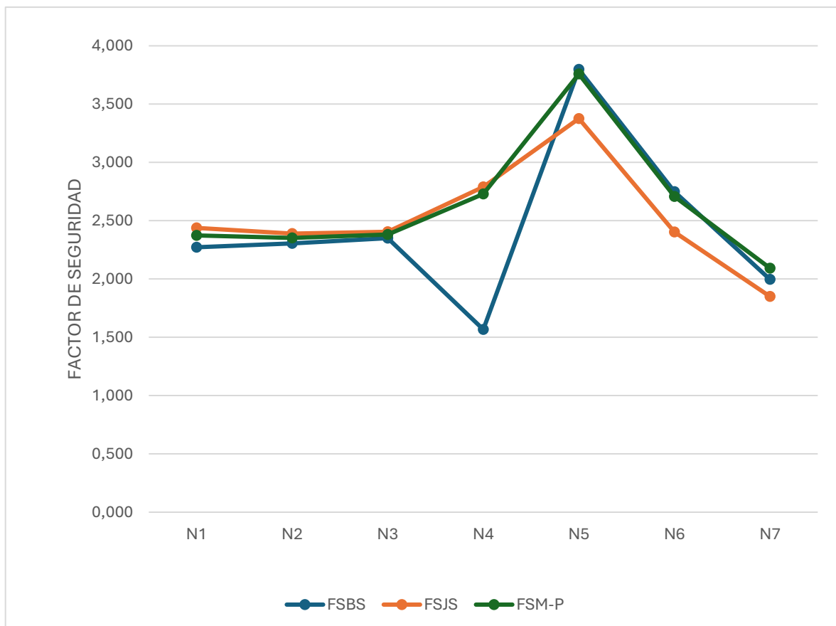
Figura 143: Gráfico de evolución del FS en el Caso 2 – Terreno 2 – D_b = 25 \text{ mm} (Fuente: Elaboración propia)
