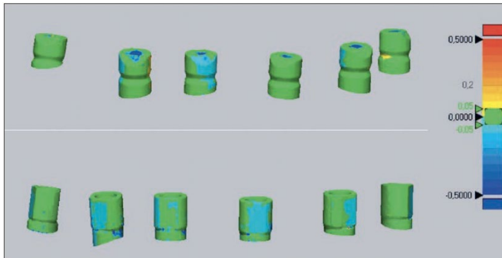
Figura 30: Mapa de color representativo de las discrepancias volumétricas medidas usando el error RMS para los ISBs de titanio médico con recubrimiento de plasma (arriba) y los ISBs de PEEK (abajo).
