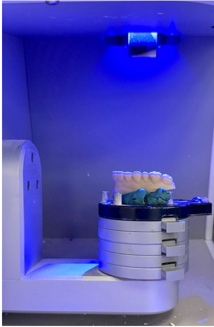
Figura 1: Procedimiento de fabricación de carillas escaneado de la fantoma con escáner extraoral MEDIT
