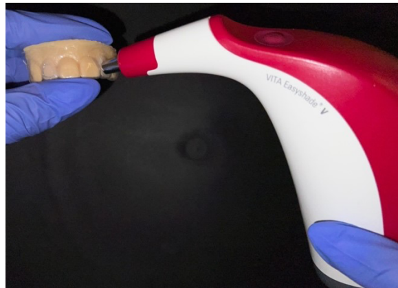
Figura 9: medición de los colores de las resinas con espectrofotómetro VITA-easyshade V
