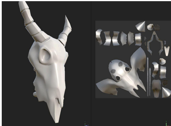
Figura 45. Bakeo final del prop "animalSkull". El espacio vacío es intencional para mantener coherente el texel density.
