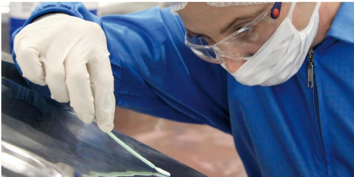
**Fotografía No. 1.** Personal realizando un hisopado para validación de limpieza.
