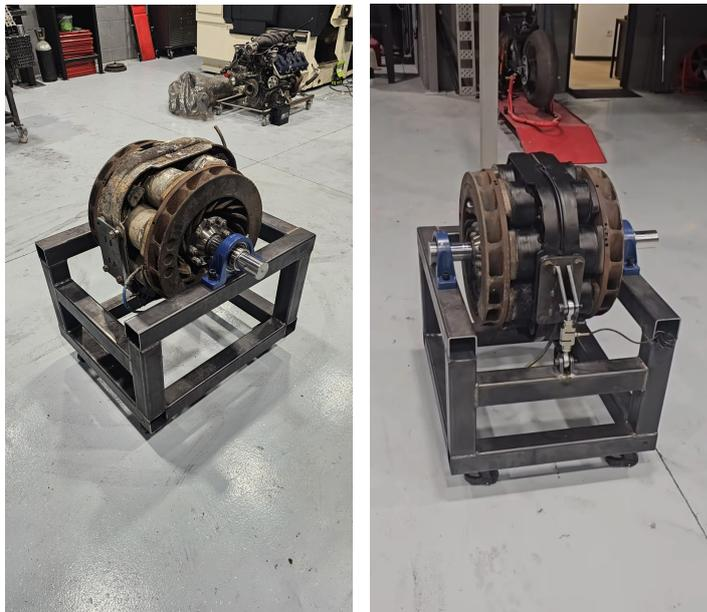
Figura 17: Montaje del freno y la célula de carga
