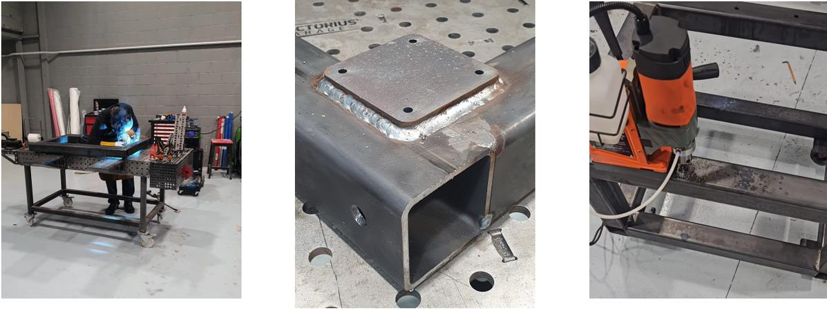
Figura 16: Soldadura de los bastidores
