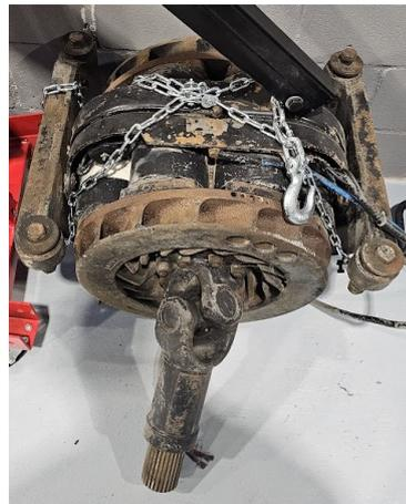
Figura 4: Freno de corrientes parásitas Telma CC250
