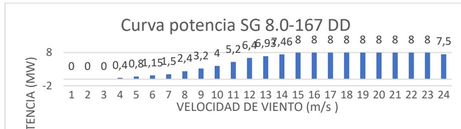
Figura 33 Curva de potencia SG 8.0-167 DD
