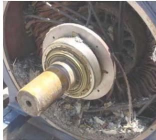
*Figura 21 Fallo en el generador eléctrico debido a la sobre velocidad*
