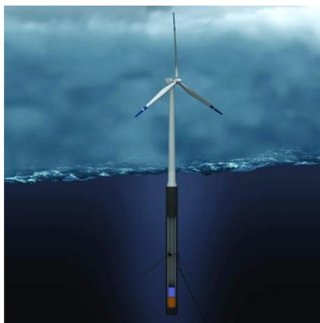
Figura 8 Plataforma spar. Fuente: (Proyecto Hywind Plataforma Flotante SPAR, s. f.)
