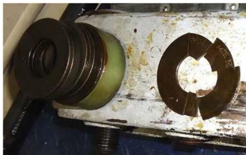
*Figura 22 Fallo en el sistema de orientación*
