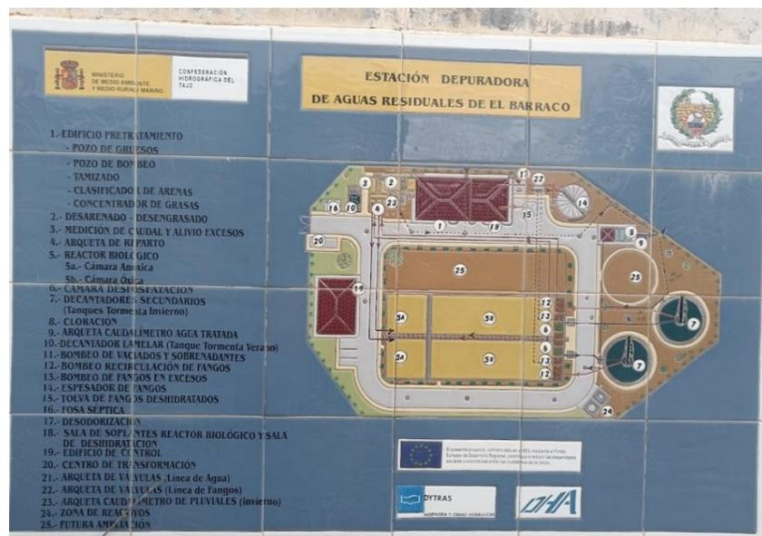
Ilustración 20. Esquema EDAR El Barraco (elaboración propia)
