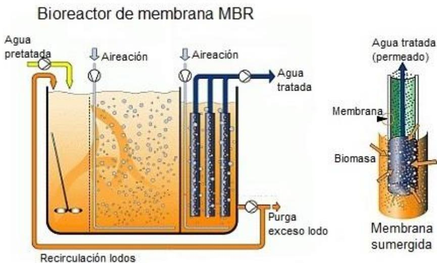
Ilustración 6. Esquema tipo de un sistema MBR («Bioreactor de membrana MBR» 2024)
