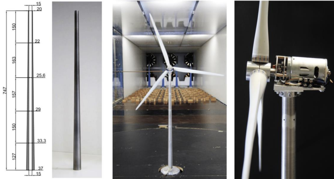
Figura 37. Túnel de viento para ensayo con aerogenerador escalado (Robert Fontecha et al)
