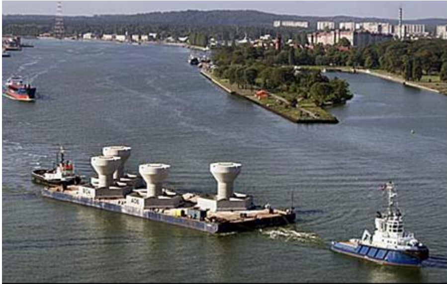
Figura 18. Transporte de cimentaciones (Vattenfall, 2008)
