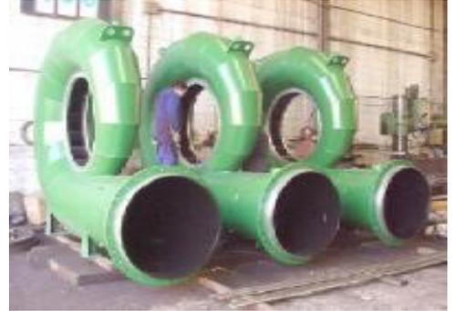
Ilustración 14. Cámara espiral armada para su instalación.
