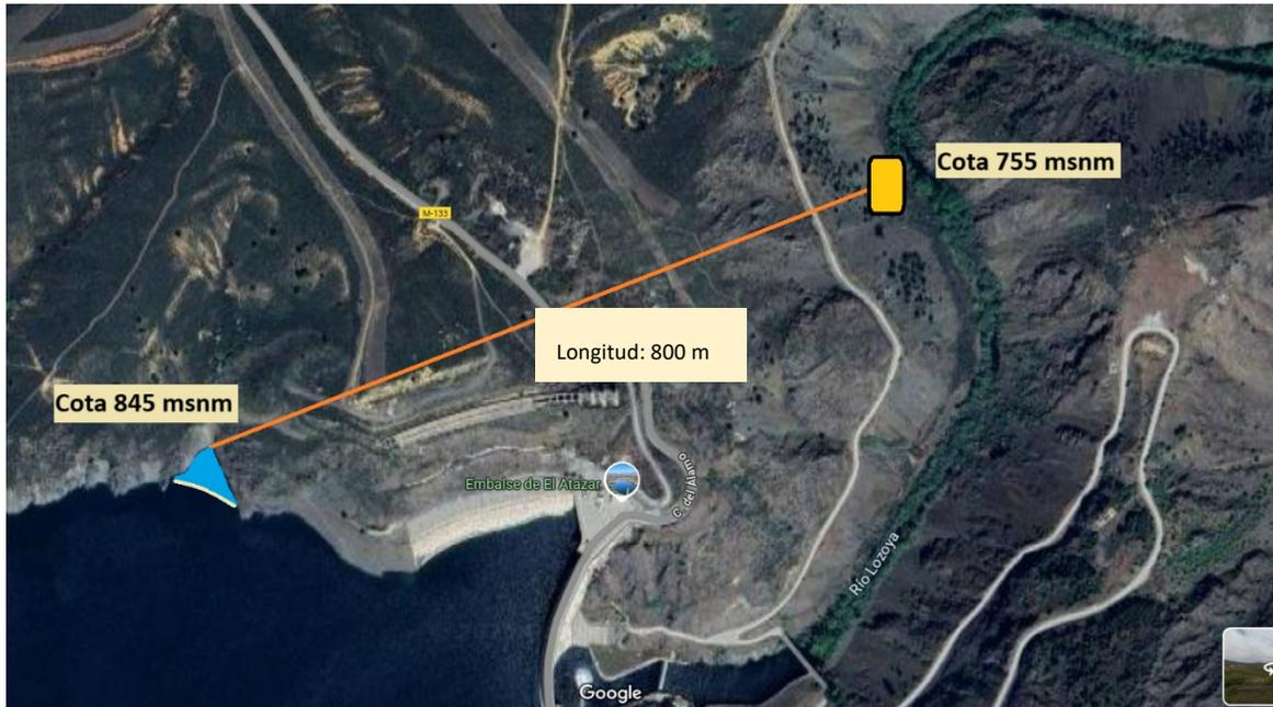
Ilustración 6. Imagen aérea de la zona, en la cual se puede observar la presa y embalse nuevos que van a construirse con una cota de 845 metros sobre el nivel del mar, la galería de 800 metros y el final de la central a una cota de 755 metros sobre el nivel del mar, con un salto bruto de 90 metros.
