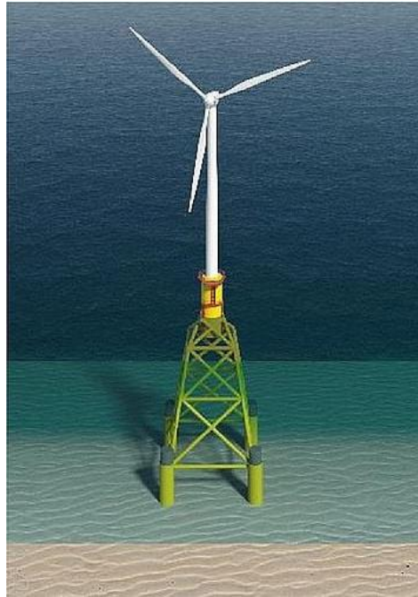
Ilustración 33 Plataforma tipo Jacket con Pilotes
