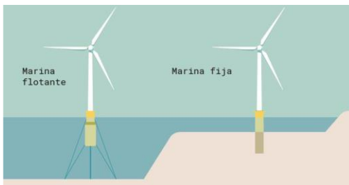
Ilustración 3 Tipos de anclajes de aerogenerador en parques eólicos marinos
