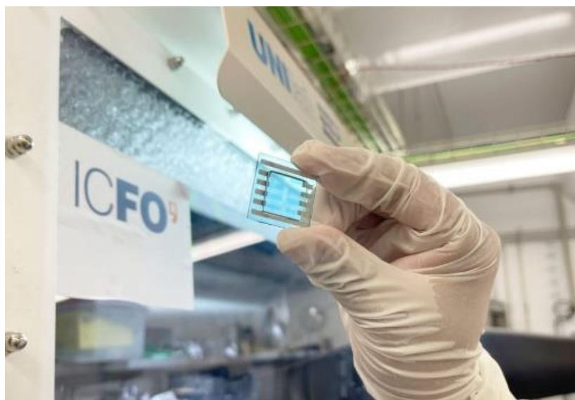
Ilustración 9 - Célula solar de perovskita (Fuente: Ecoinventos)
