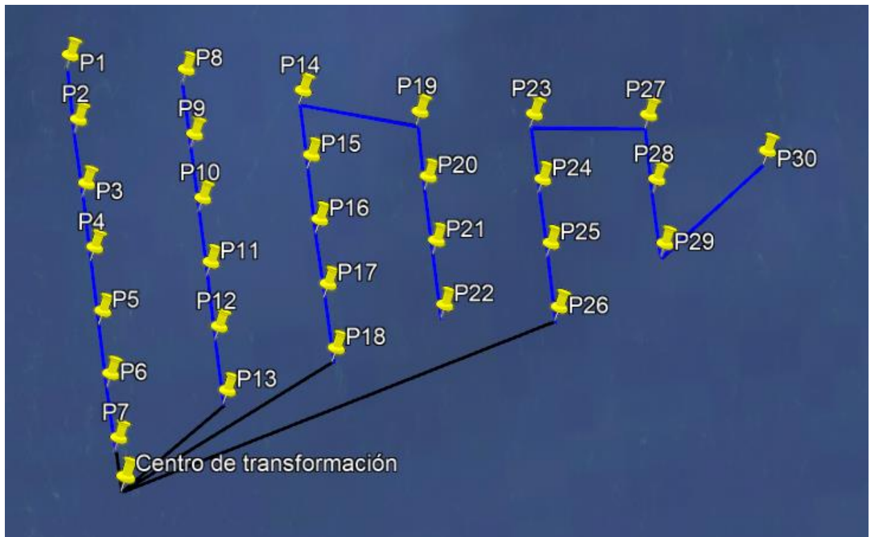
Ilustración 22: Conexiones entre aerogeneradores y el centro de transformación
