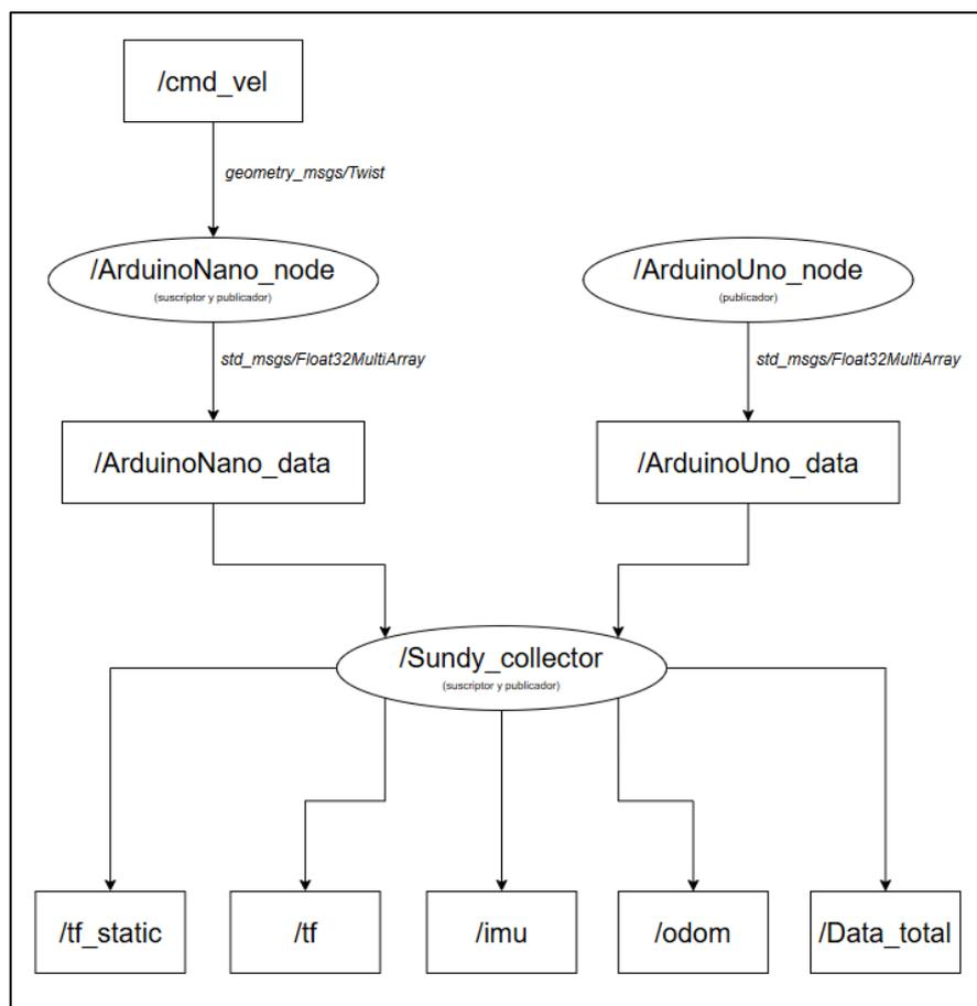
**Figura 83:** Arquitectura con Arduino Uno y Nano
