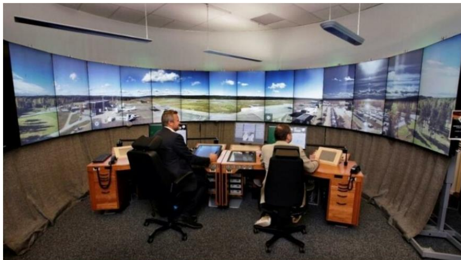
Ilustración 35. Sala remota con dos CWP con sus sistemas. Sundsvall tower Control, Sweden.
