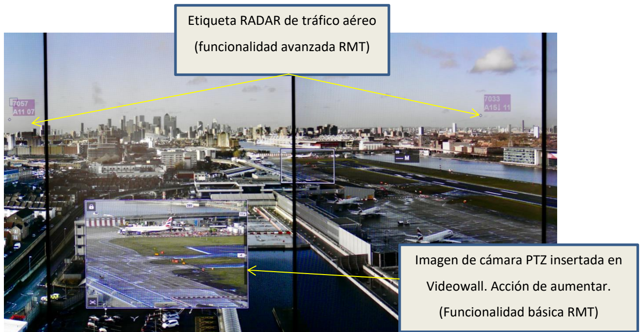
Ilustración 8. Detalles Videowall de torre remota. Aeropuerto de London City
