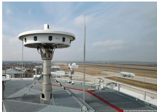
Ilustración 31. Cámaras fijas y PTZ. Erfurt Weimar Airport. Germany
