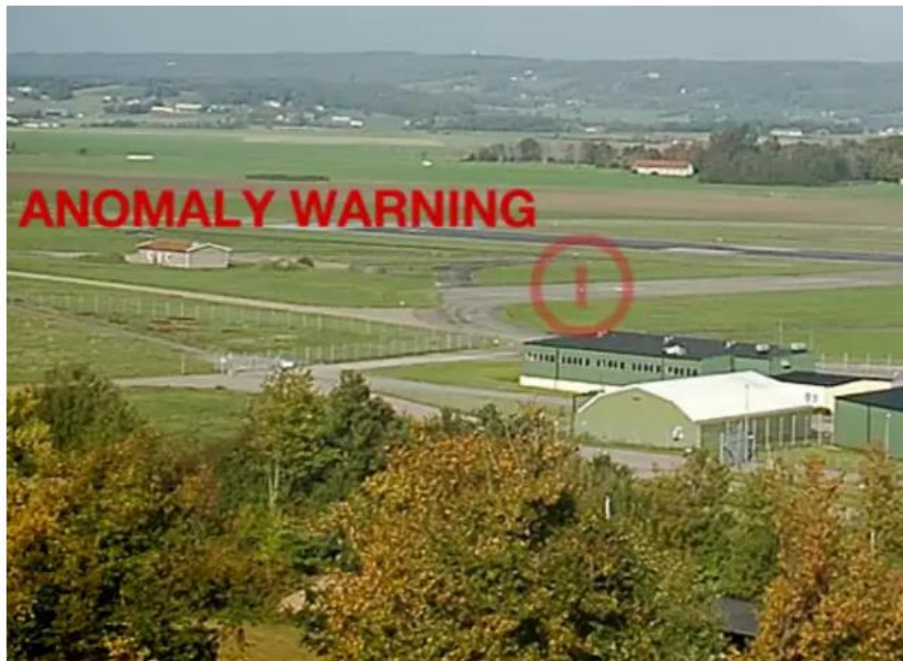
Ilustración 38. Función Visual tracking en videowall. FOD. Fabricante Saab
