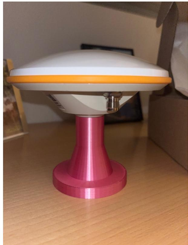
Figura 37 Soporte imprimido en 3D para la base
