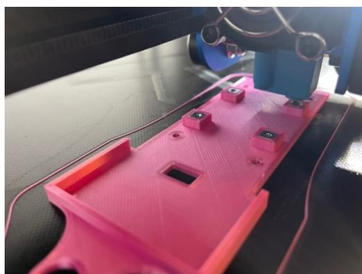
*Figura 29 Impresión 3D con incrustación de tuercas en estructura*
