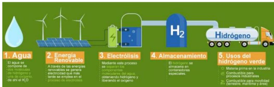
Figura 25. Esquema de obtención del Hidrogeno Verde
