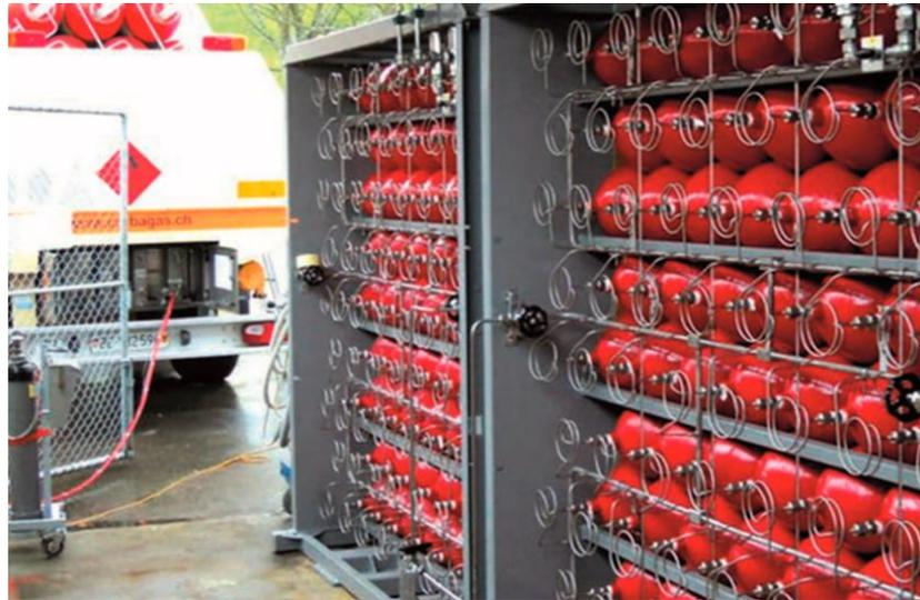
*Figura 21. Racks de botellas del fabricante Calvera Hydrogen*
