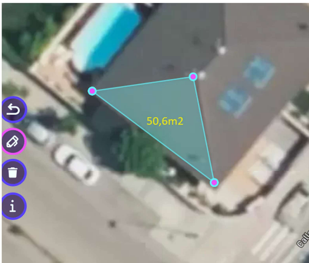
Figura 66. Superficie de cubierta para paneles en orientación SUROESTE. Fuente: Octopus Energy
