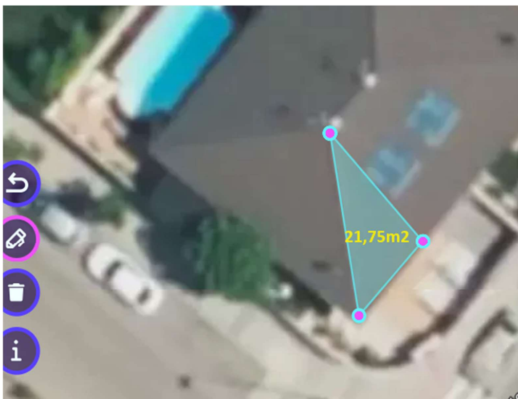
Figura 68. Superficie de cubierta para paneles en orientación SURESTE. Fuente: Octopus Energy
