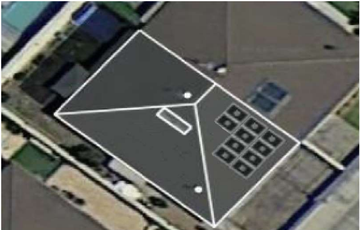
Figura 79. Disposición de los paneles en cubierta SURESTE. Fuente: Elaboración propia.
